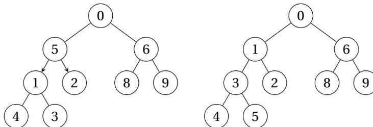
FIGURE 5 – Tas min : à gauche, l'élément 5 doit descendre dans le tas min. À droite, on a échangé la place de 5 avec le fils le plus petit (d'abord 1 puis 3) pour que la structure soit conforme à un tas min
