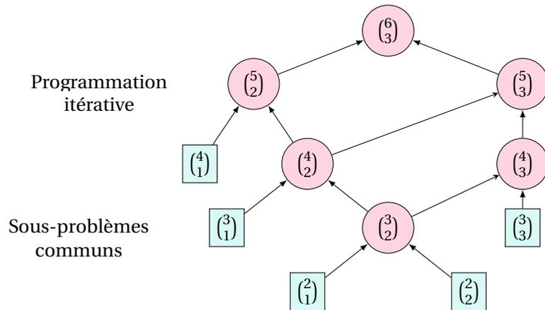
FIGURE 2 – Programmation itérative du calcul de  $\binom{6}{3}$ . Les rectangles correspondent à un cas terminal de la récursivité, les cercles à l’application de la formule récursive. **Les sous-problèmes se chevauchent** : par exemple, le calcul de  $\binom{3}{2}$  est utilisé par le calcul de  $\binom{4}{2}$  et  $\binom{4}{3}$ . En effectuant un calcul de bas en haut, l’idée est de ne le calculer qu’une seule fois ces éléments.
