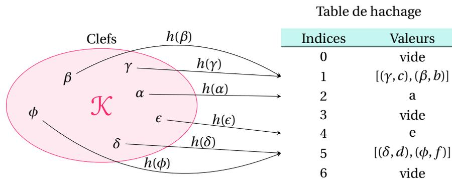
FIGURE 4 – Illustration de l'implémentation d'un dictionnaire par table de hachage avec chaînage. Les clefs  $\beta$  et  $\phi$ , engendrent des collisions. On stocke donc les valeurs possibles pour un même code (indice) dans une liste.
